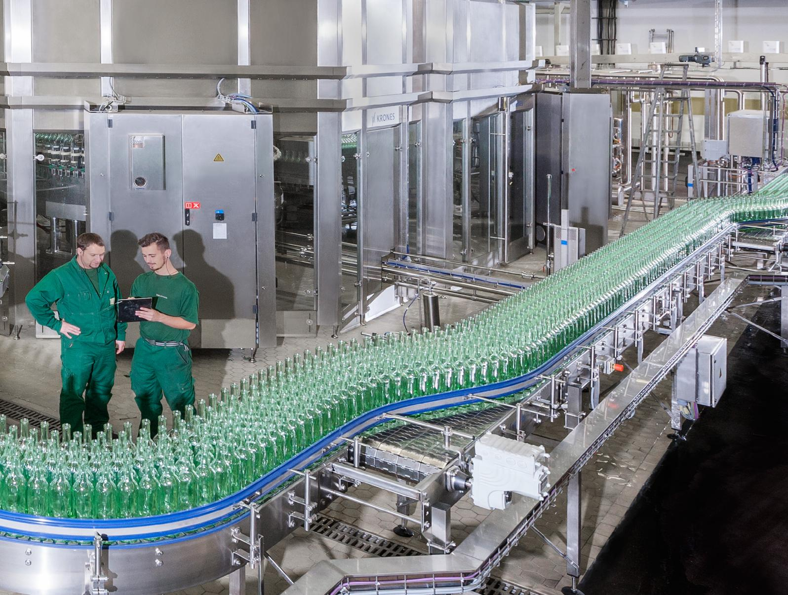
Durch die Karussellaufstellung der Maschinen profitieren die betreuenden Mitarbeiter von kurzen Wegen und durch die optimierte Flaschenführung von einem deutlich geringeren Lärmpegel.
